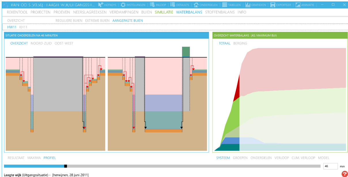
Figuur 3 RainTools waterbalans gesimuleerd met bui Herwijnen met de weergave van de berekende waterstanden in de schematische doorsneden van het plangebied.
